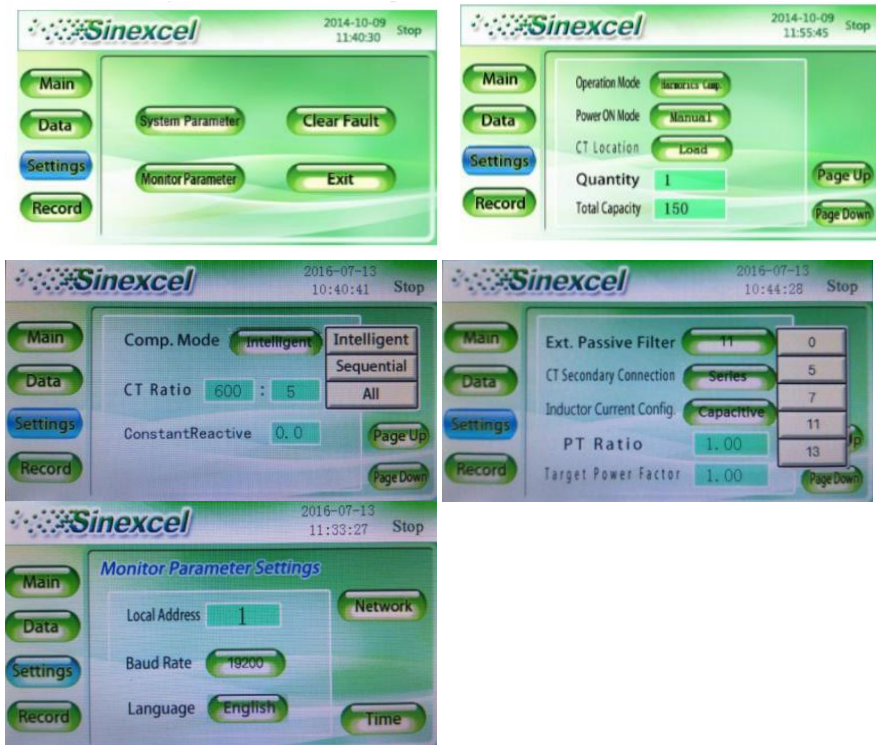
Rys. 5. Zdjęcia panelu sterowania - podstawowa parametryzacja wyświetlacza 4".
