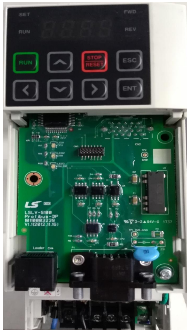
Rysunek 4. Widok karty Profibus z wyświetlaczem 7-segmentowym
