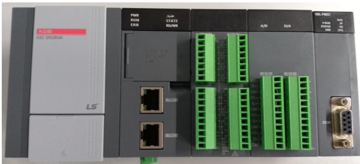
Rysunek 5. Sterownik PLC – XEC-DR28UA z zamontowaną kartą komunikacyjną XBL-PMEC
